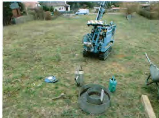
Abbildung 6: Flurstück 285/1 – nordöstlicher Teil; Blick Richtung Südwest zur Straße, Versickerungsversuch am 04.03.2019
