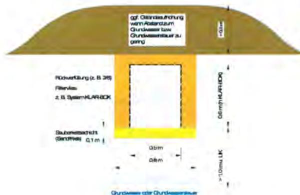
Abbildung 9: Prinzipdarstellung Querschnitt Rigole mit Füllkörpern und Geländeaufhöhung
