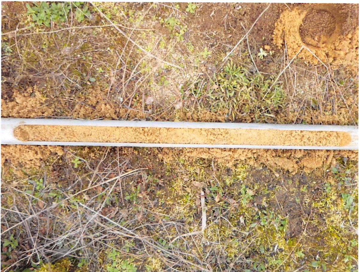
Bild 6: Bohrung 9, Bereich 2,0-2,5 m, Mittelsand, feinsandig, schwach grobsandig.
