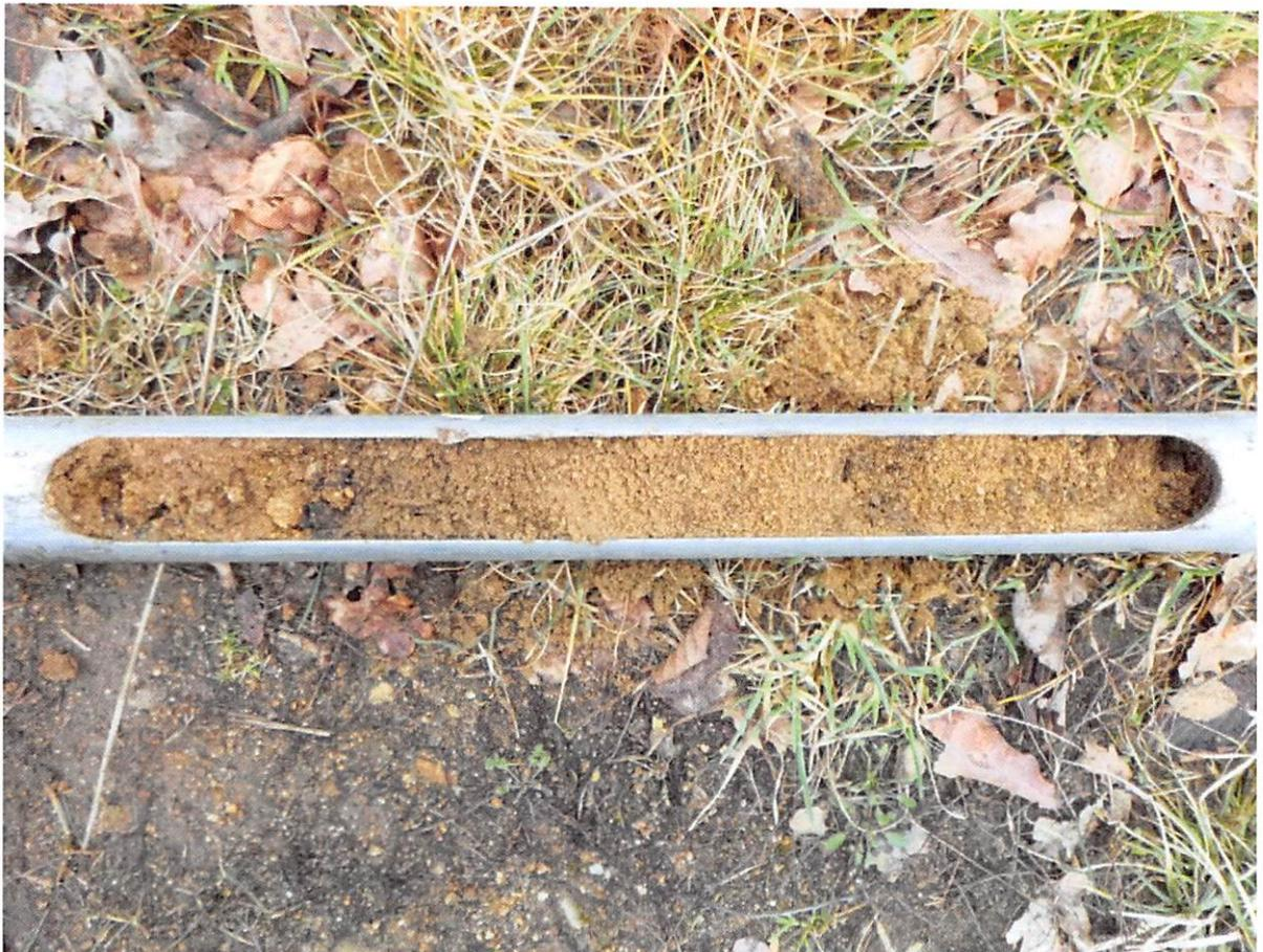
Bild 4: Bohrung 2, Bereich 0,5-1,0 m, Mittelsand, feinsandig, schwach schluffig.
