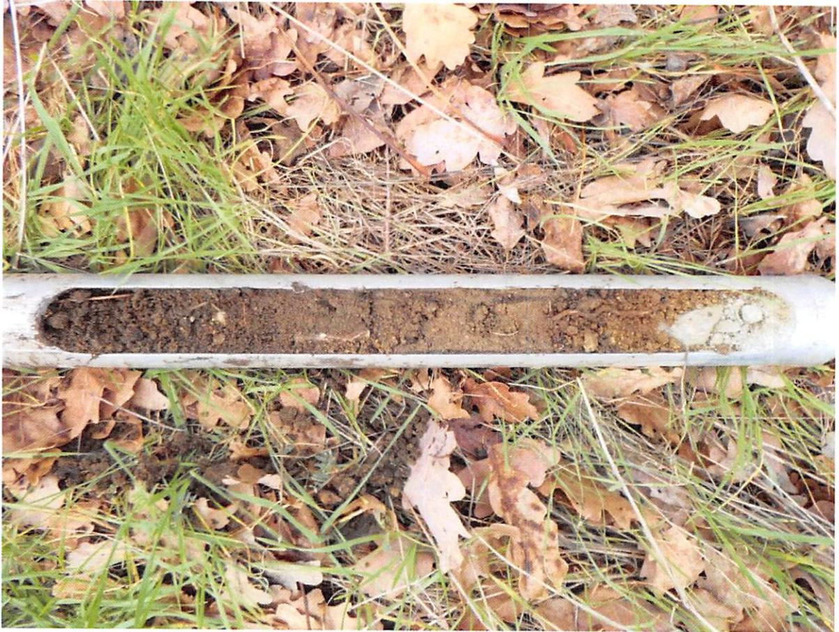
Bild 5: Bohrung 4, Bereich bis 0,6 m, Grobkies bis Fels, entfestigt, unter Auffüllungen.
