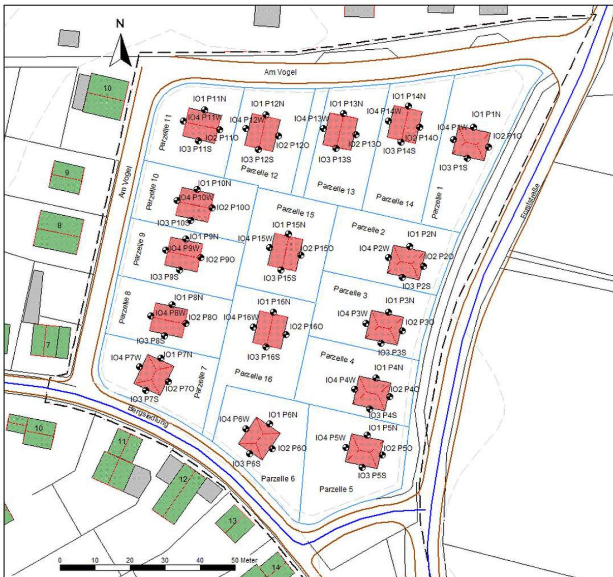
Abbildung 11: Lageplan (Rechenmodell) des B-Planareals mit den geplanten Gebäuden sowie Immissionsorten
