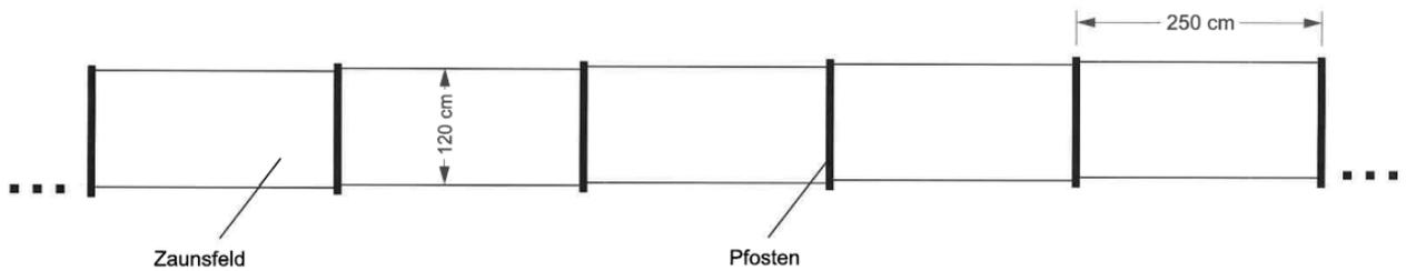
schematische Darstellung eines Ausschnittes der Einfriedung mit fünf Zaunsfeldern und sechs Pfosten unter Berücksichtigung von Gefälle (beispielhaft)
