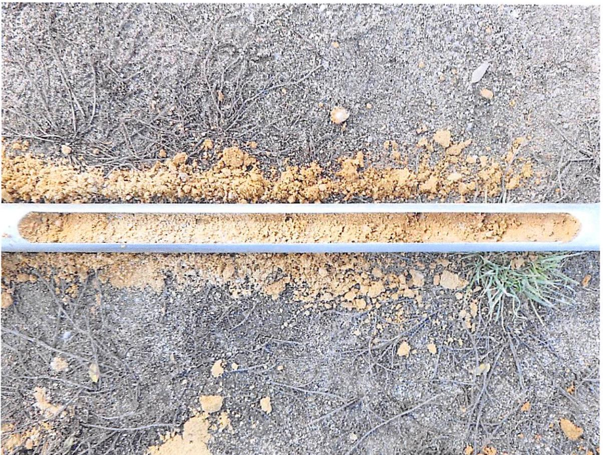
Bild 6: Tieferer Bereich bis 5,0 m, Feinsand bis Mittelsand.
