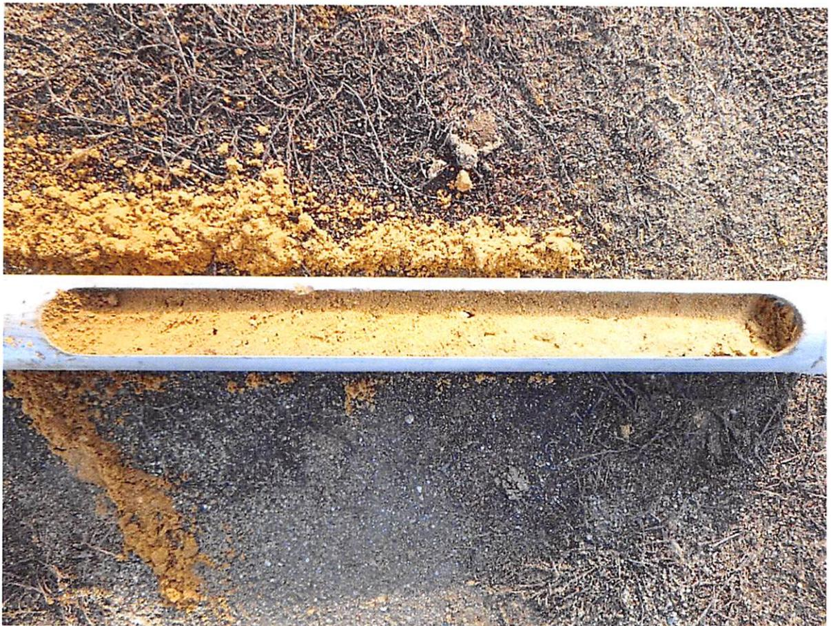
Bild 4: Bohrung 1, Bereich 0,5-1,0 m, Mittelsand, feinsandig bis stark feinsandig.
