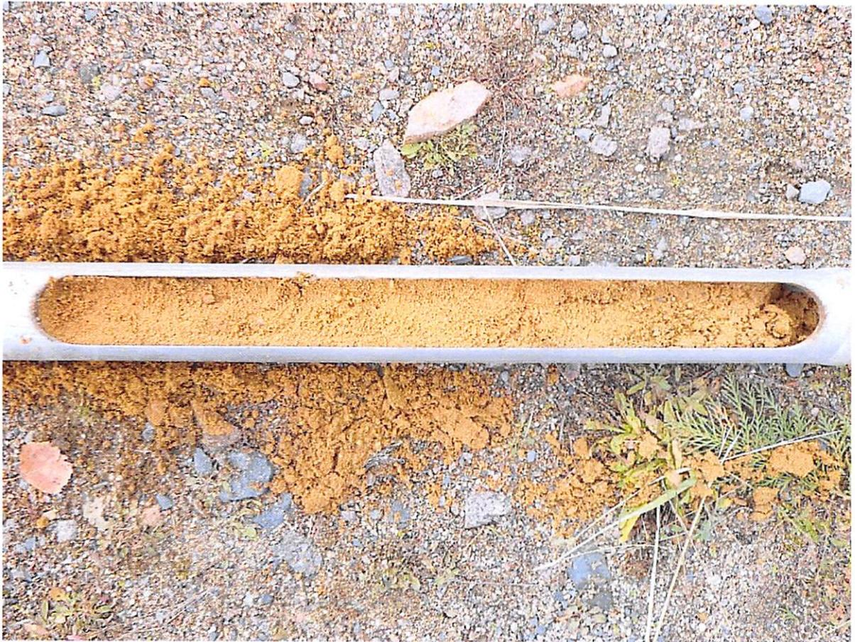
Bild 5: Bohrung 3, Bereich 0,5-1,0 m, Mittelsand, feinsandig.
